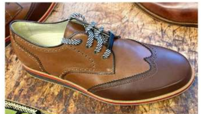
Ein fertiges Modell eines handgemachten Schuhs. Der dunkelbraune vordere Teil nennt sich Blatt, der mittlere Teil Quartier.
