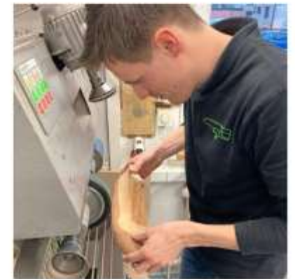
An der Schleifmaschine arbeitet Andreas Schäfer den Leisten nach.
